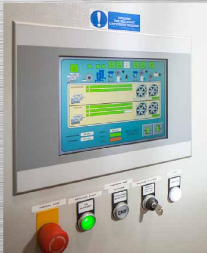
Pannello operatore touch screen per controllo linea Operator's touch-screen panel for control of the line Panneau opérateur à écran tactile pour le contrôle de la ligne Сенсорная панель оператора для управления линией
