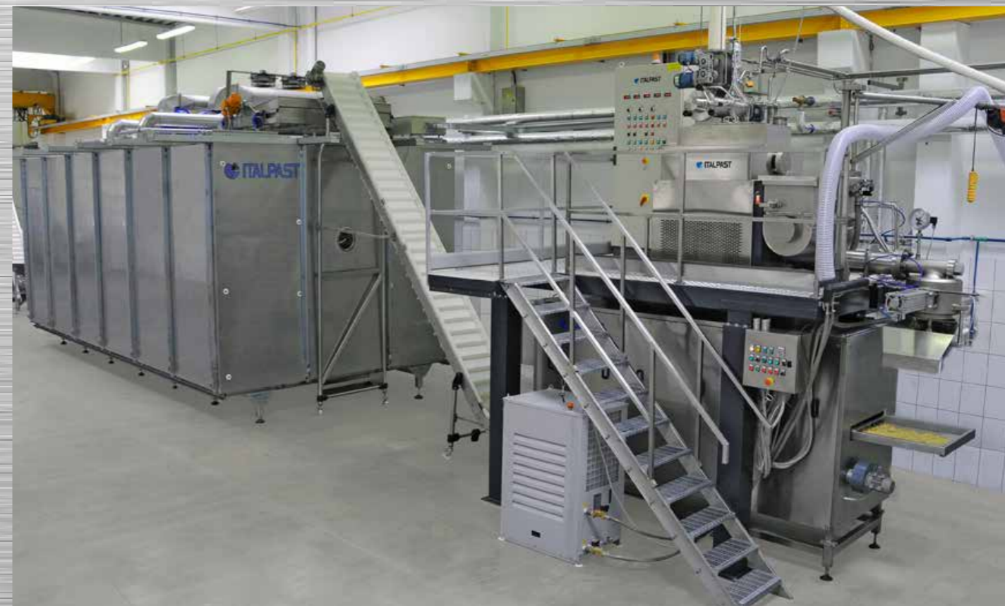
Impianto per produzione pasta corta con Essiccatoio automatico continuo Short pasta production line with automatic continuous Dryer Unité de production de pâtes courtes avec Séchoir automatique continu Производство коротких макаронных изделий с непрерывной сушилкой
