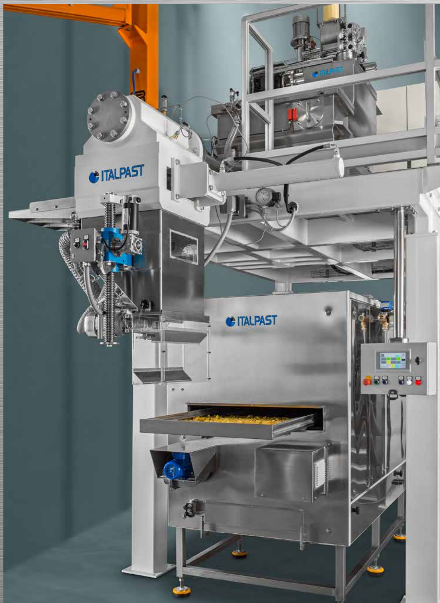
Pressa modello MAC700 vuoto totale con Trabatto di preincarto Total vacuum Extruder mod. MAC700 with Pre-dryer Presse modèle MAC700 sous-vide total avec Pré-séchoir Пресс MAC 700 полный вакуум с трабатто
