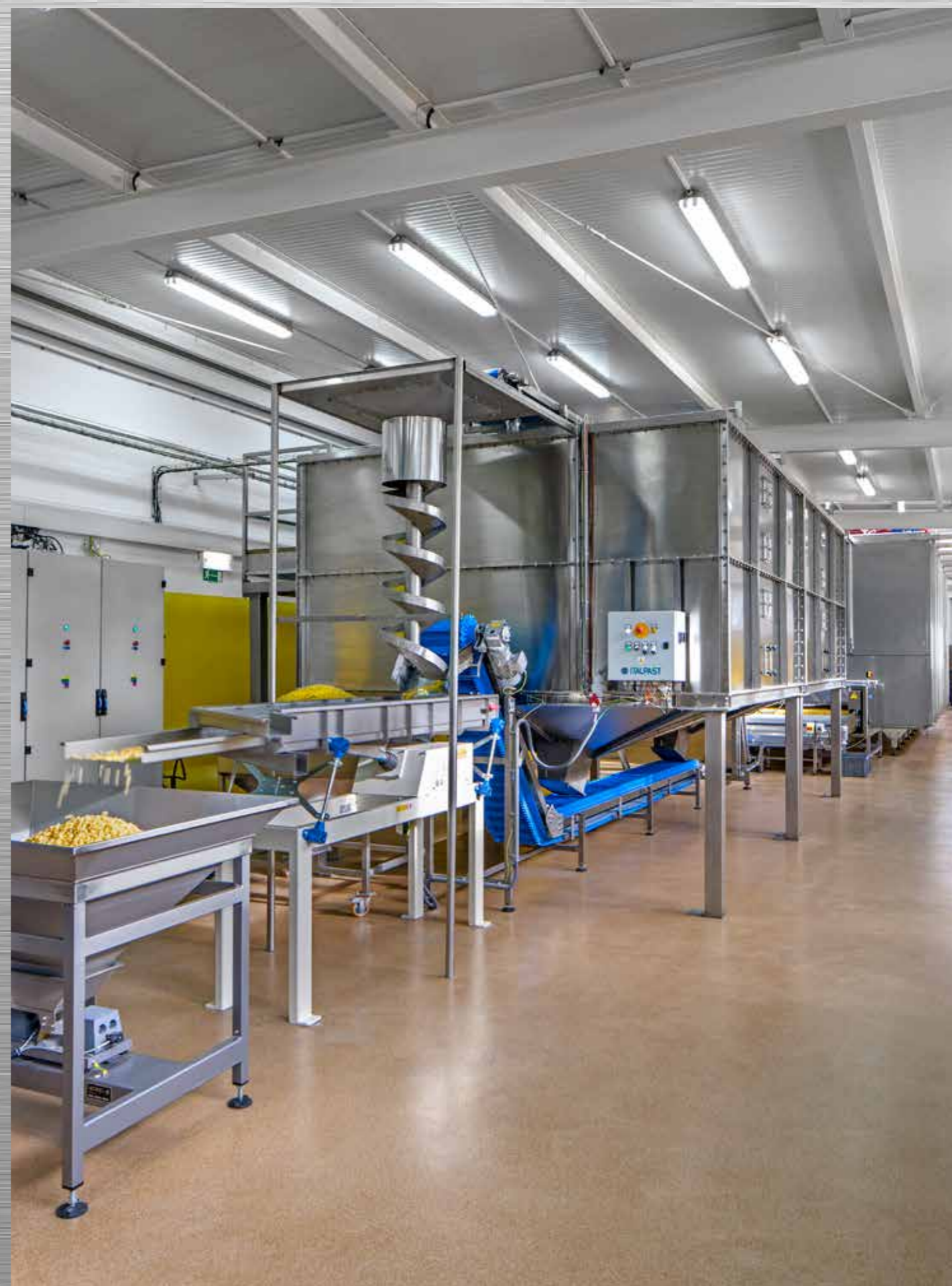
Raffreddatore per pasta secca Dry pasta Cooler Refroidisseur pour pâtes sèches Охладитель для высушенных макаронных изделий
