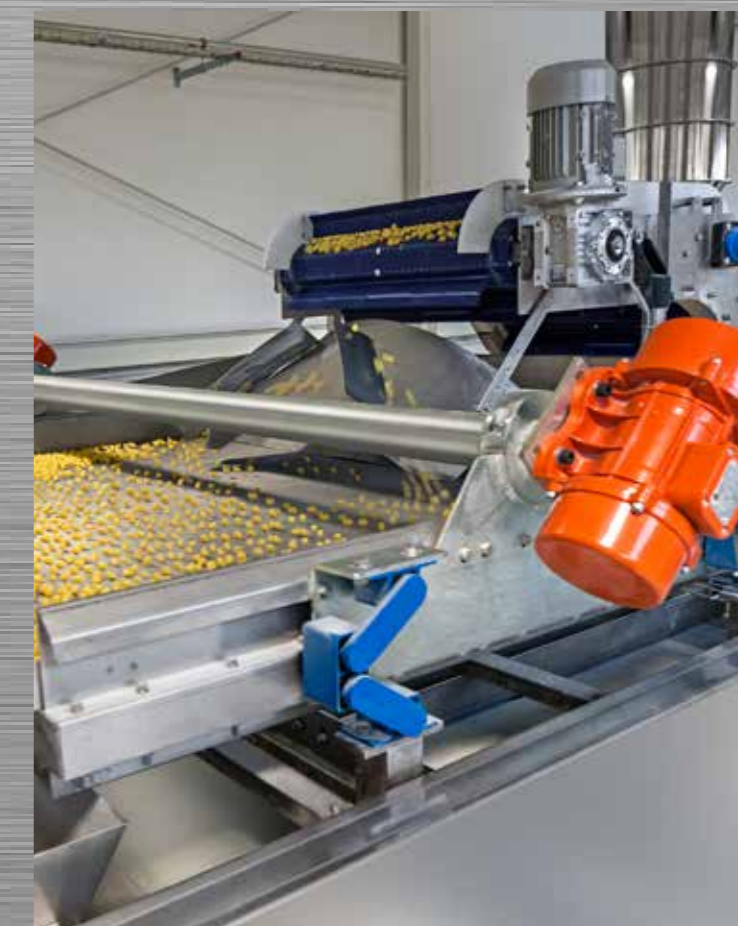
Essiccatoio automatico continuo • Automatic continuous Dryer • Séchoir automatique continu • Сушилка непрерывная автоматическая
