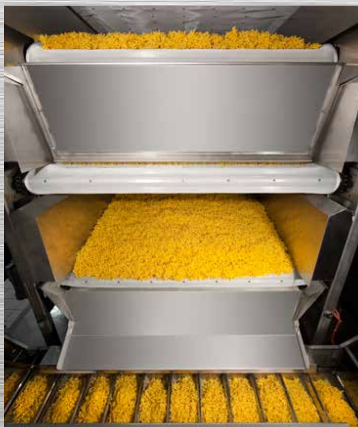
Particolare tappeti Essiccatoio automatico continuo Detail of belts of automatic continuous Dryer Détail des tapis du Séchoir automatique continu фрагмент ленты непрерывной автоматической сушилки
